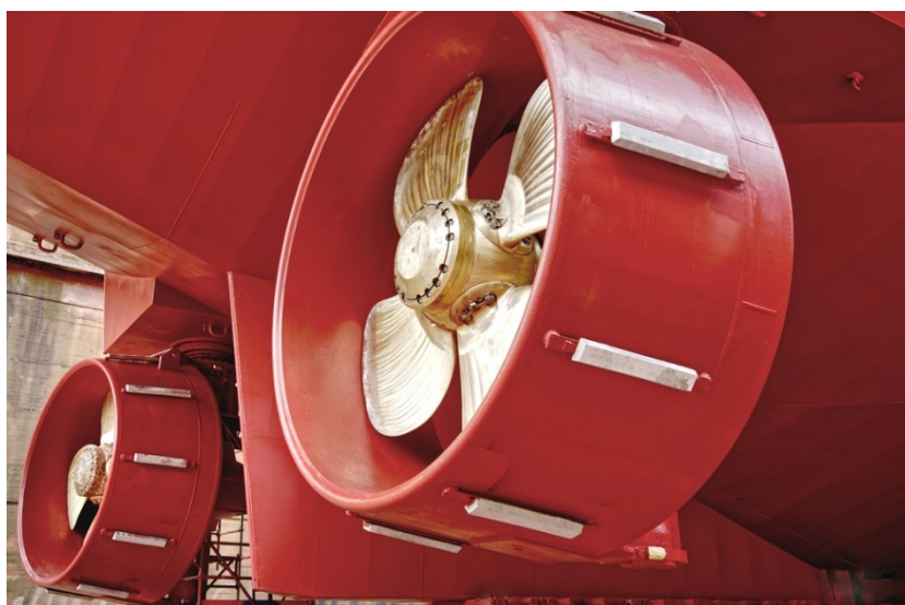
Slika 12 - Primjer zaštite žrtvenim anodama na propulziji broda
