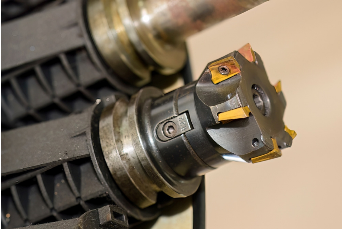
Slika 7 - Alat za glodanje čelika s keramičkim oštricama
