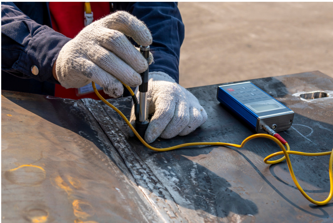
Slika 14 - Prikaz ispitivanja tvrdoće
